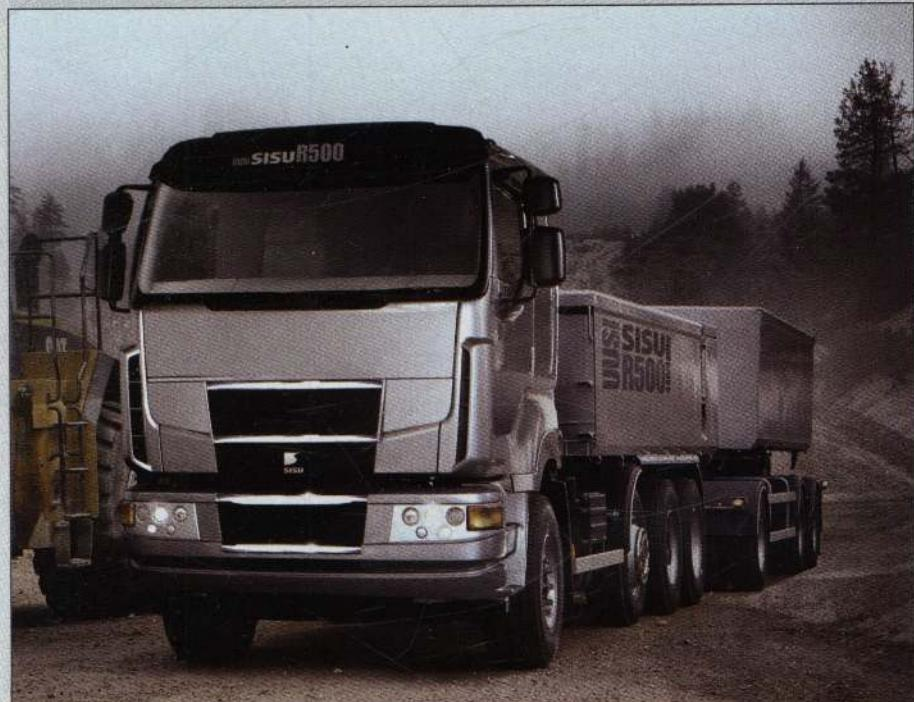
Как и ранее, грузовики SISU будут выпускаться с интерпретированной по-фински кабиной Premium, только на этот раз адаптации подвергся последний вариант, представленный Renault Trucks осенью прошлого года. Идея использования большей по габаритам силовой установки Caterpillar C15 потребовала увеличить моторный туннель, а вместе с этим подкорректировали также интерьер кабины.
