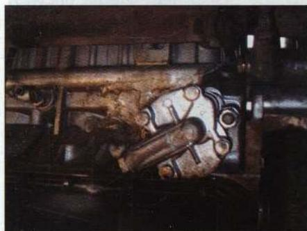
Крохотное отверстие обернулось вырванным куском металла в районе 7 и 8 цилиндров
