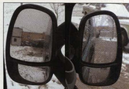
Зеркала имеют по две секции, нижние считаются панорамными
