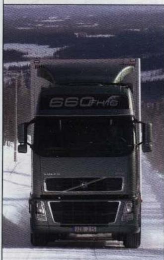
увеличилась – на 15%. Моторы работают с автоматизированными коробками передач I-Shift. Напомним, что тягачи такой мощности предназначены в первую очередь для работы в составе автопоездов массой 60 и более тонн, а значит, ориентированы в первую очередь на эксплуатацию в скандинавских странах повышенными дорожными нормами.
