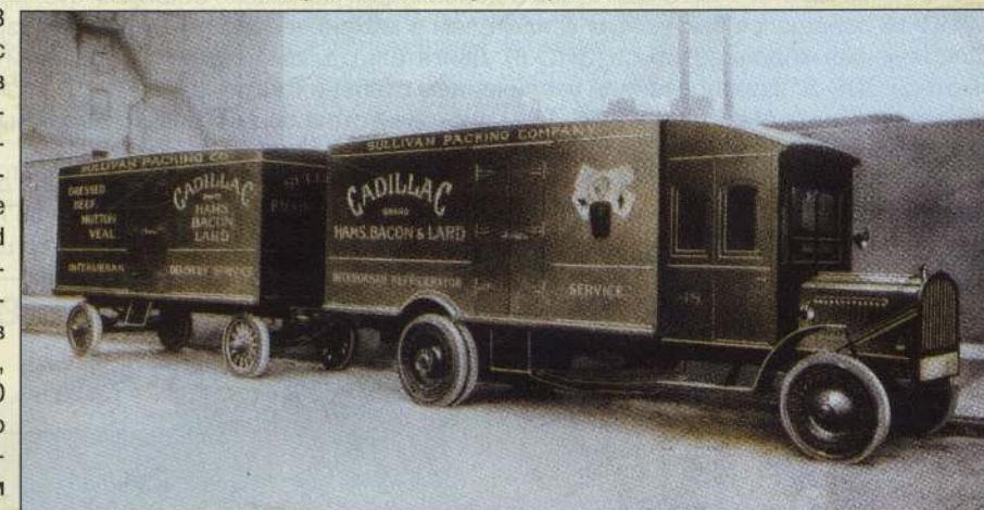
Образец первых автопоездов (рефрижератор) Packard, 1923 г.
