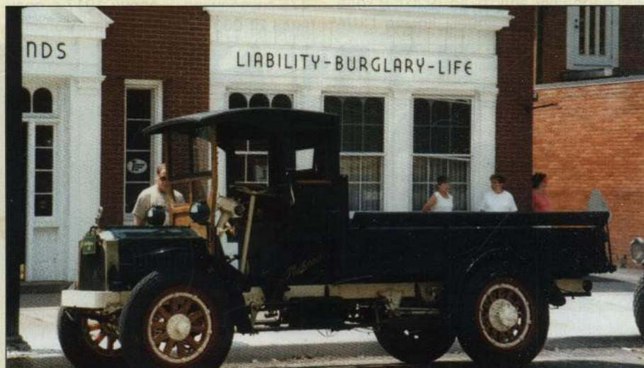
Packard 1915 г., 1,5-тонная модель «D» с трехступенчатой коробкой
