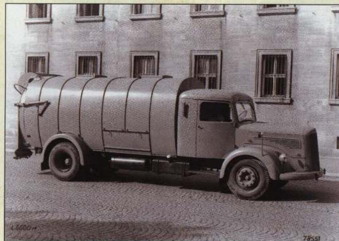
**И кабина, и спецнадстройка изготовлены сторонними фирмами**
