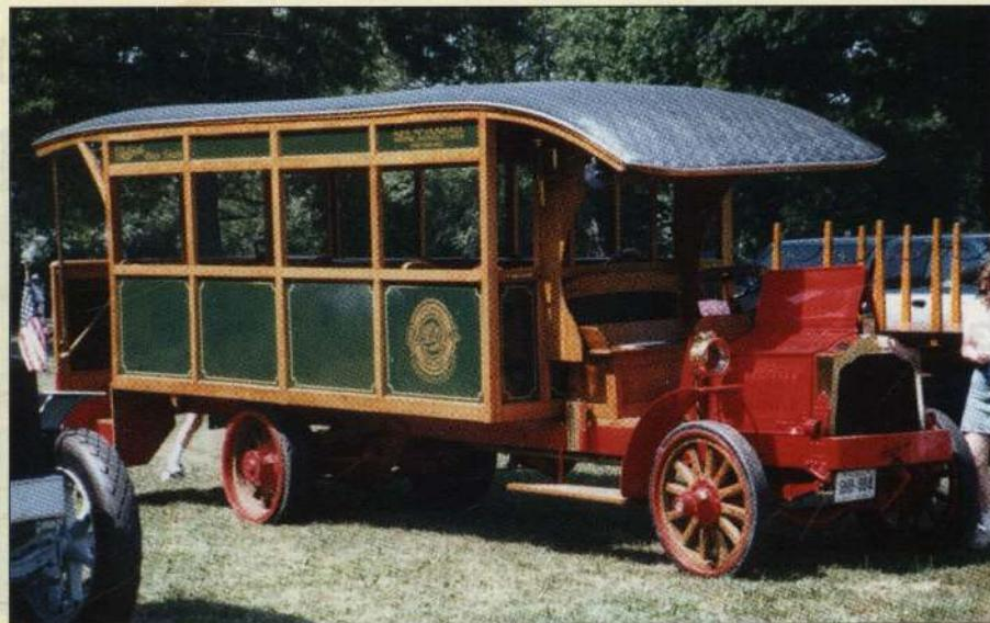
Packard 1916 г. грузоподъемностью 2,5 т с автобусной надстройкой
