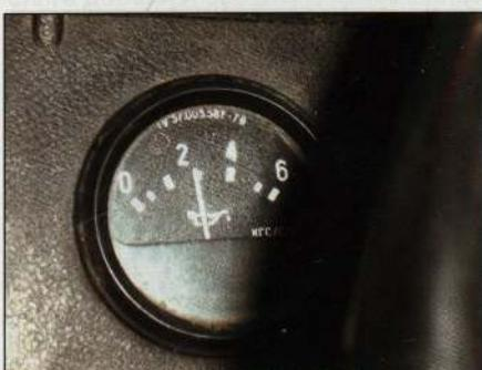
**После ремонта давление еле дотягивает до тройки: блок изношен**
